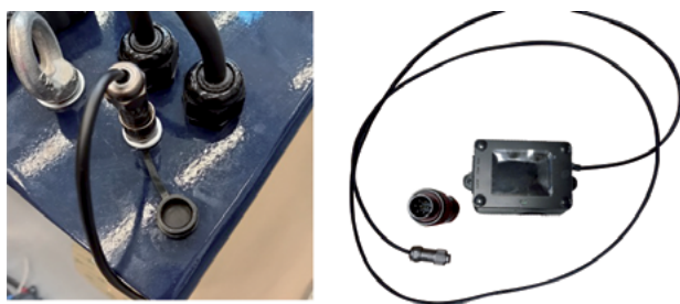
Slika 5 Povezivanje kompaktnog displeja sa baterijom
