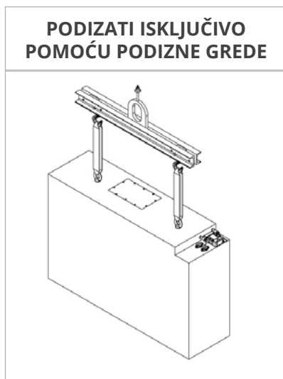
Slika 2a Podizanje baterije sa očnih vijaka montiranih na nosaču
