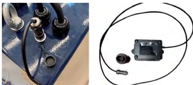
Imaginea 5 Conectarea afișajului compact la baterie
