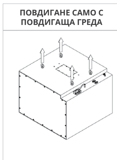
Фигура 2а Повдигане на батерията от болтовете с халки, монтирани на поставката
